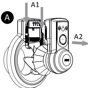
Lyft motorenheten ur ramstycket (se fig A) genom att först skjuta de båda låsknapparna mot centrum (A1). Tag därefter loss motorenheten (A2).
